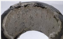
Результат определения физического износа труб МЕНЕЕ 40%
